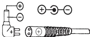
Se l'ingresso del dispositivo da alimentare ha il **polo negativo centrale**, prendere in mano il cavo d'uscita dell'alimentatore e individuare il segno -. Prendere il connettore prescelto, individuare il segno - e inserire il connettore nel ricettacolo del cavo d'uscita dell'alimentatore prestando molta attenzione che il segno - del connettore prescelto combaci col segno + sul ricettacolo.
