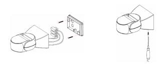
• Far passare il cavo di connessione alla rete elettrica attraverso la guarnizione posta sotto il sensore, prestando attenzione a non aprirla eccessivamente per non compromettere il grado di protezione IP. Ora eseguire i collegamenti come da schema seguente.
