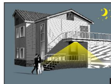
Quando la luce naturale è al di sotto della soglia impostata per il sensore crepuscolare, la plafoniera viene accesa se il sensore rileva dei movimenti.
