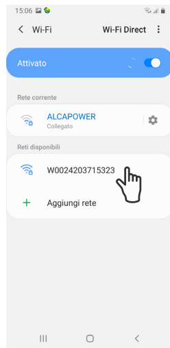
4. Collegarsi direttamente alla rete generata dal controllo remoto. Nota: l'identificatore della rete, nella figura W0024203715323, corrisponde al Part Number (PN) del controllo remoto ed è anche presente sull'etichetta con codice a barre sul fondo del controllo remoto.
